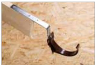
**2)** к стропильным ногам через удлинитель кронштейна прямой (применяется на этапе монтажа кровли); в случае, когда шаг кронштейнов не совпадает с шагом деревянных стропил, рекомендуется крепить прямой удлинитель кронштейна или металлический кронштейн в ОСП-3, заранее подготовив сплошное основание.
