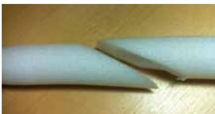
Прокладки соединяют «на ус», при помощи клейкой полиэтиленовой или матерчатой изоляционной ленты на расстоянии не менее 30–40 см от места пересечения вертикального и горизонтального стыков. Уплотнять стыки двумя скрученными вместе прокладками не допускается. В месте пересечения стыков прокладку в вертикальном стыке располагают ближе к фасадной поверхности.
