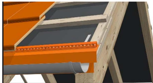
1. Ендова является одним из наиболее уязвимых мест на каждом кровельном покрытии, именно здесь часто случаются протечки, поэтому нуждается в особенно тщательной обработке.
