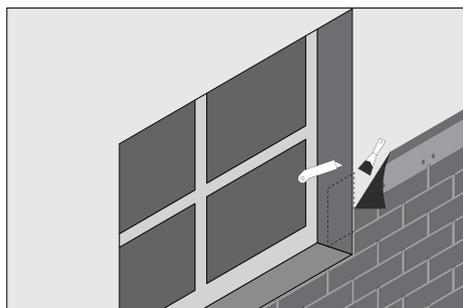
Рис. 8.1. Монтаж фасадной плитки вокруг оконных проемов
