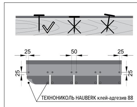
Рис. 1.1. Схема крепления фасадной плитки
