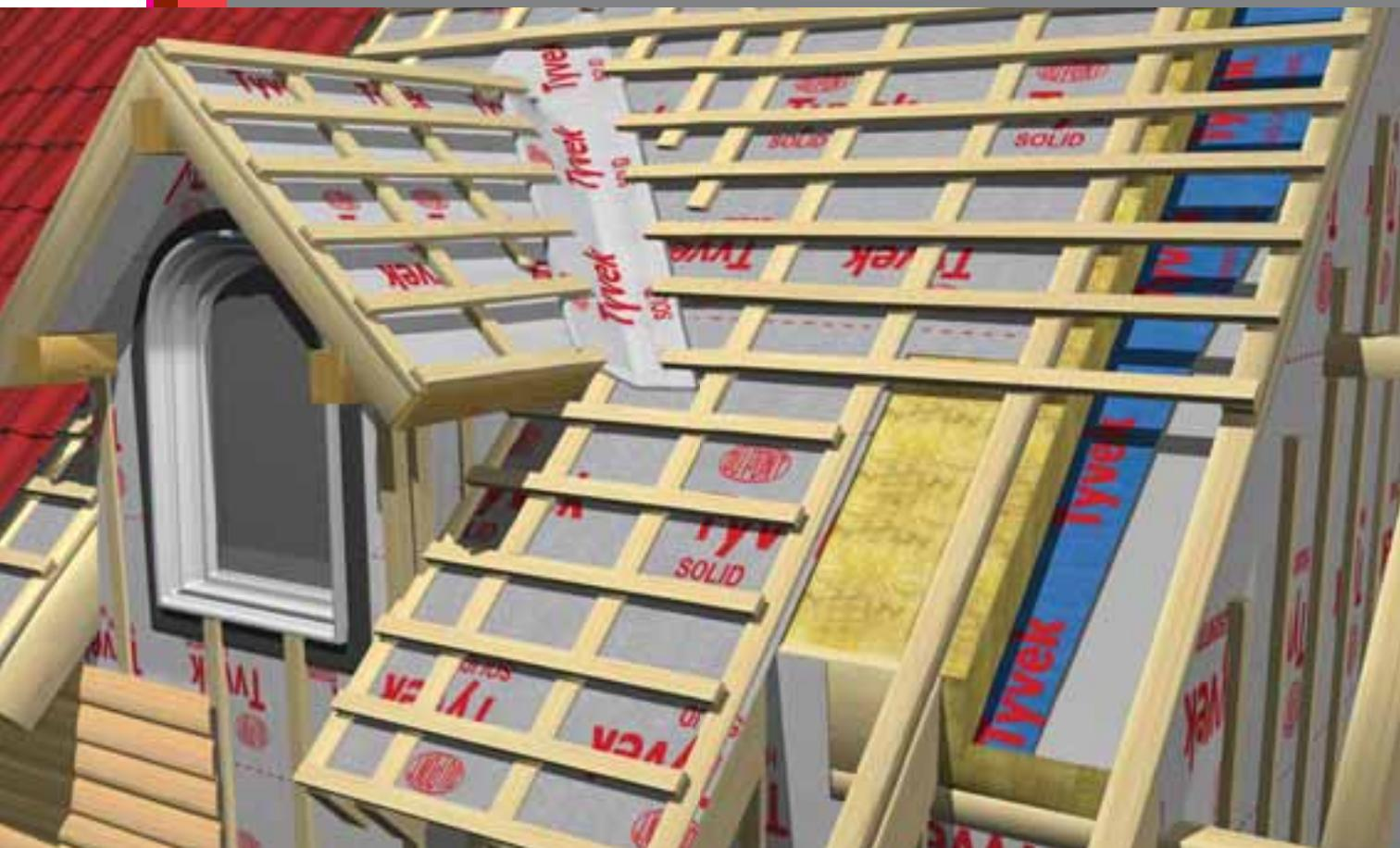
**Рис.1 Устройство утепленной мансарды**
