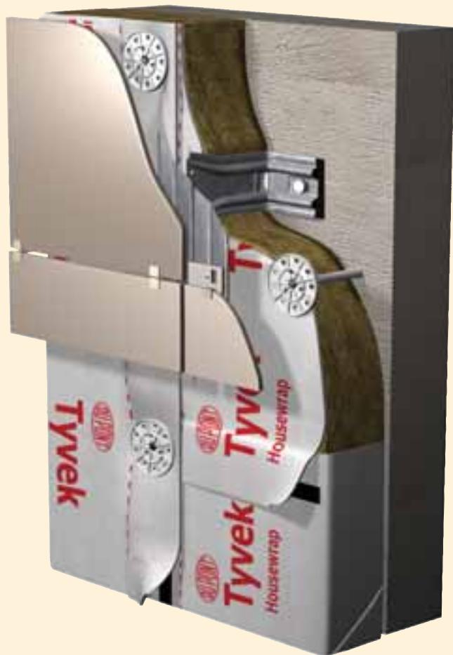
Рис. 9 Системы навесных вентилируемых фасадов
