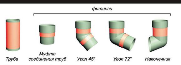
Крепление трубы и фитингов производится при помощи хомута универсального.
